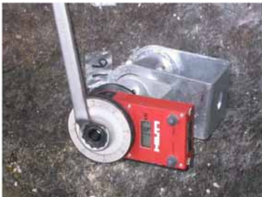
写真16→報告書(9) 引き抜き荷重 19.6
