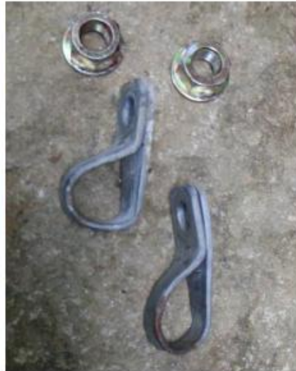
(e) 左が元のハンガー。右下が、落下テストにより延びたハンガー。
