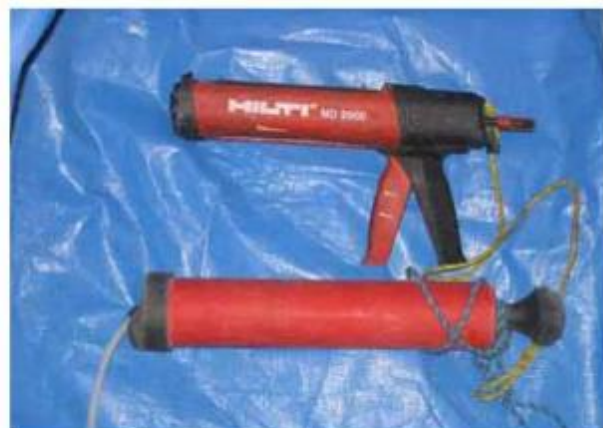
専用の押し出し器 HILTI マニュアルデスペンサーMD2000と 掃除用ポンプ（下側）
