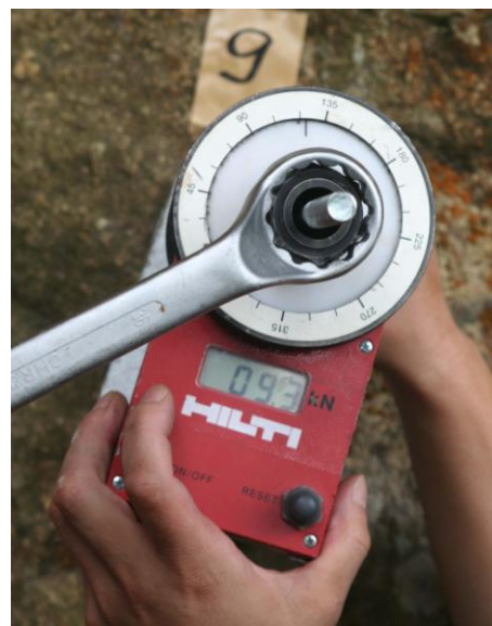
レンチを回しながら引き抜きを行い、数値データを写真に記録した。
